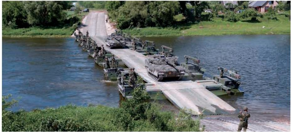
**System M3: Als Brücke oder mehrteilige Fähre einsetzbar.**
