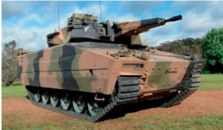
Rheinmetall Lynx KF41 im Versuch mit Verbundgummikette.
