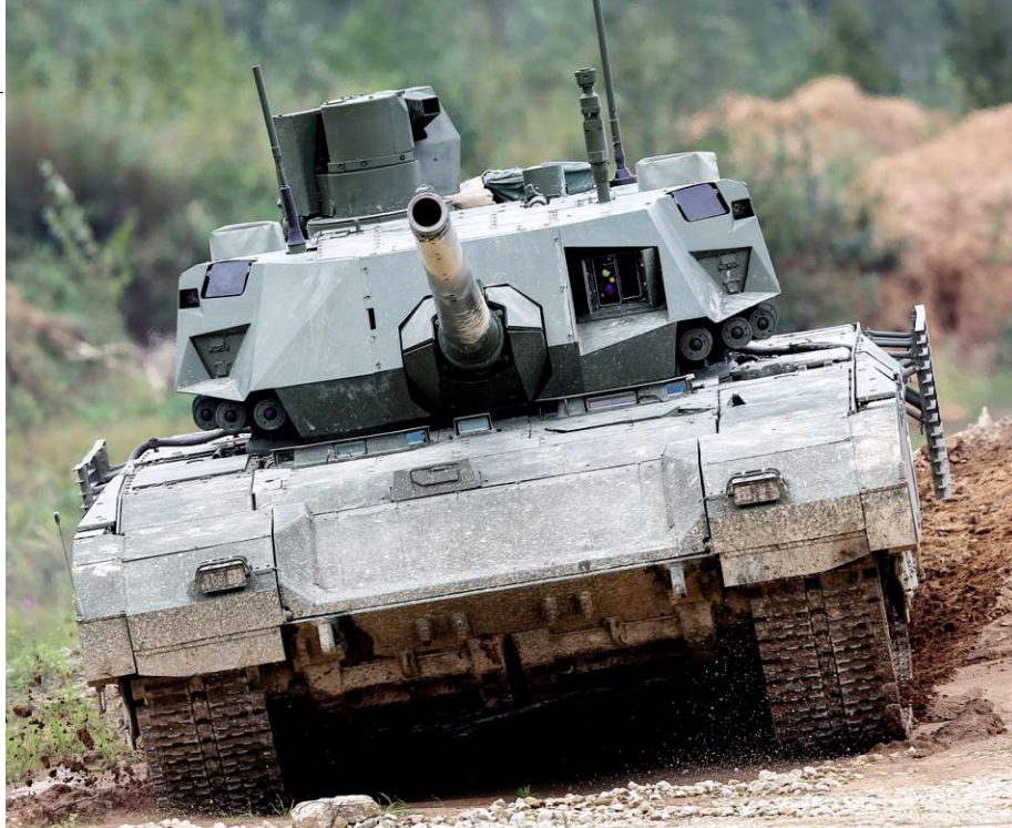
T-14 im Gelände. Die Ketten sind schmaler als beim Leopard oder Abrams.
