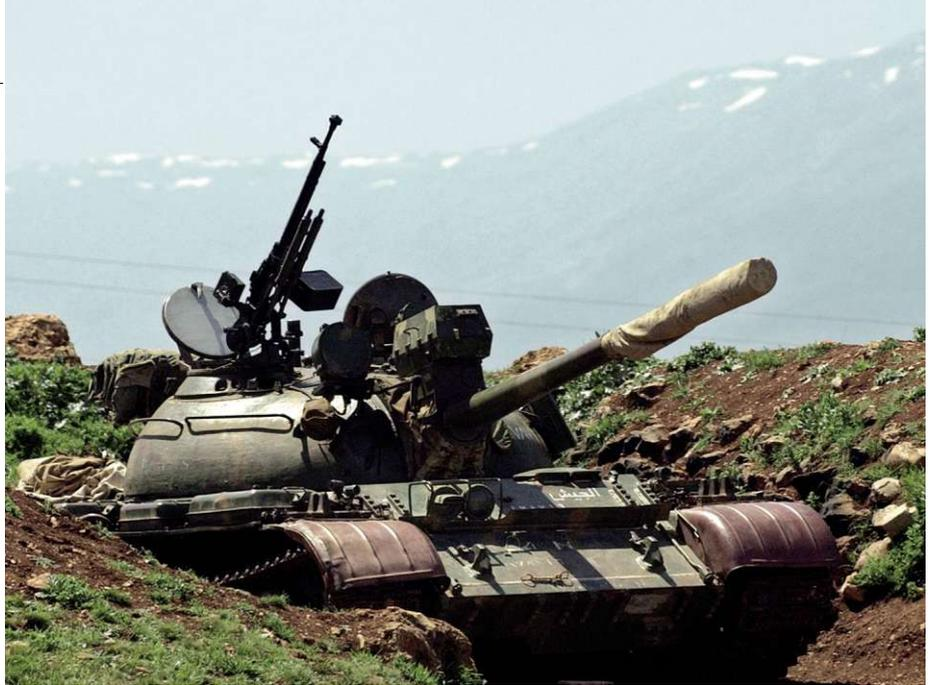
**Syrien: T-55 am Fuss des Hermon. Grün, die Schutzbleche braun. Die Mündungsbremse vorne kennzeichnet den T-55 (ein weiteres Merkmal wäre das Fahrwerk).**
