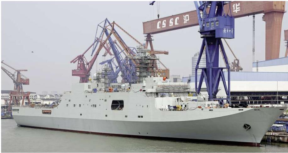
**Zu den neuen amphibischen Einheiten gehören auch die Docklandungsschiffe des Typs 071, derzeit sind 7 Schiffe vorhanden. Diese Einheit der «Yuzhao»-Klasse hat in Shanghai festgemacht. Die Schiffe sind knapp 20 000 to gross, 210 m lang und können bis zu vier Luftkissenfahrzeuge des Typs 726 sowie bis zu 6 Helikopter mitführen.**
