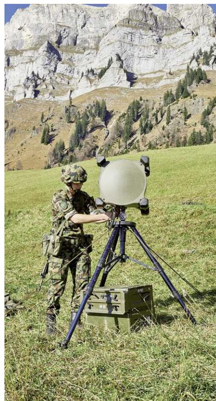
Das statisch eingesetzte Richtstrahlsystem R-905 der Schweizer Armee mit hoher Autonomie und Datendurchsatz.
