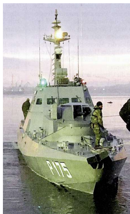
Oberst i Gst Jürg Kürsener: «Das Patrouillenboot P-175 verfügt vorne und achtern über je einen ferngesteuerten 30-mm-Zwilling (Turm, je zwei 30-mm-Granatwerfer, je zwei 6.6 MG).»
