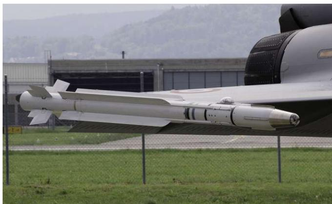
MICA-Luft/Luft-Raketen mit IR-Suchkopf am Flügelende.
