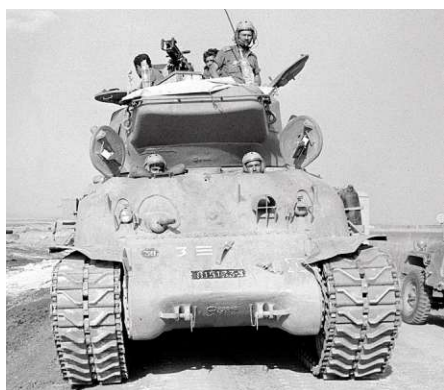
Super-Sherman. Israel ersetzte die 75-mm-CN-Geschütze durch eine französische 105-mm-Kanone Typ D-1508 L/51.
