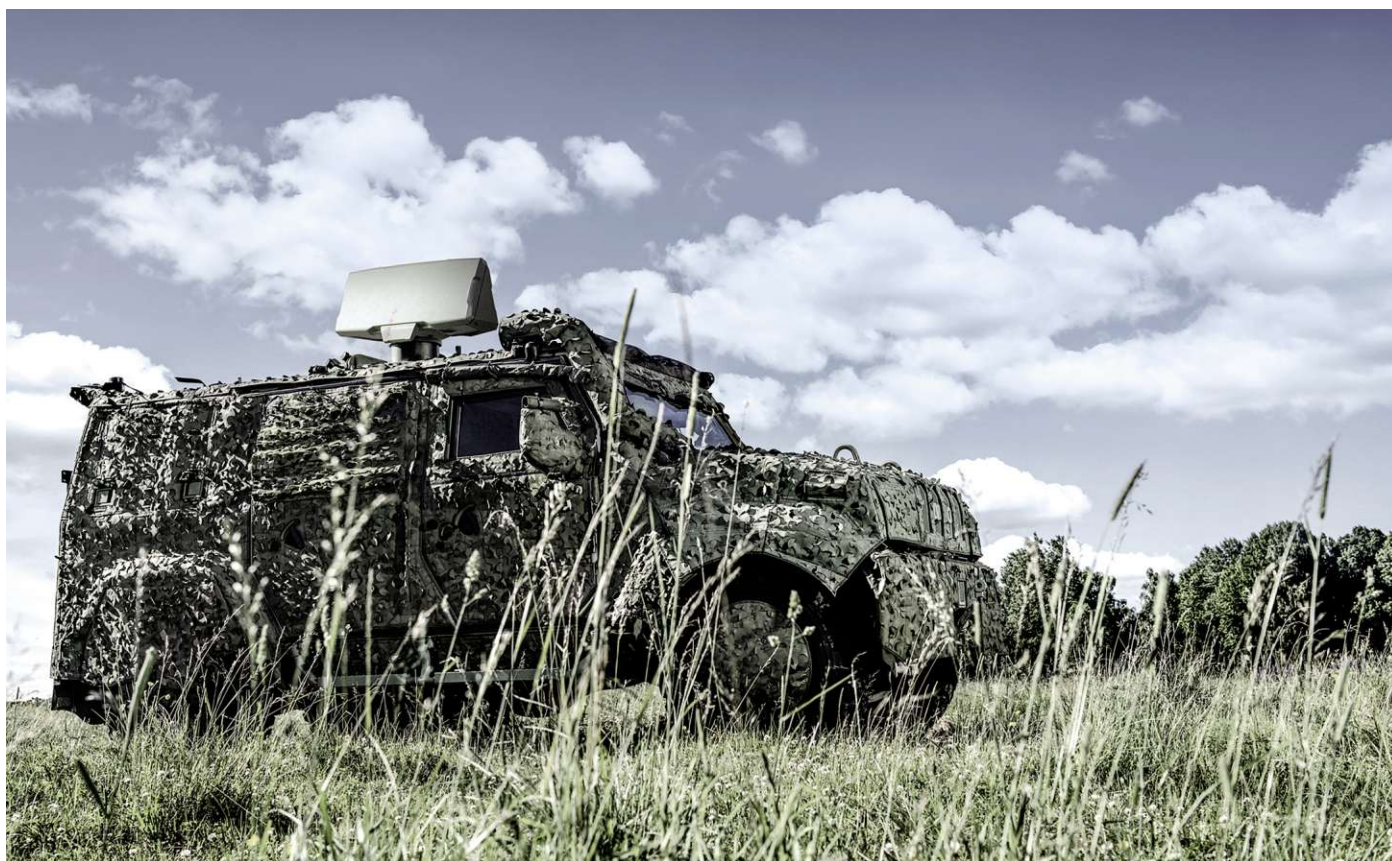
Radarsystem Giraffe: Einsatzmittel auf Flughäfen zur Identifizierung und Klassifizierung von Drohnen.
