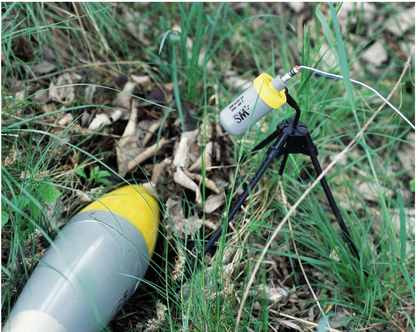
Zerstörung eines Blindgängers.
