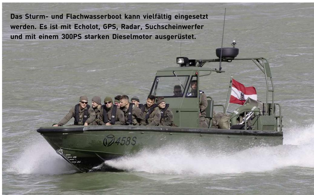
**Das Sturm- und Flachwasserboot kann vielfältig eingesetzt werden. Es ist mit Echolot, GPS, Radar, Suchscheinwerfer und mit einem 300PS starken Dieselmotor ausgerüstet.**
