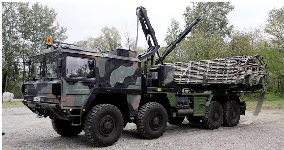
**Faltstrassengerät:** nach der Verlegung der Faltstrasse auf weichem, sandigem oder morastigen Untergrund kann diese mit schweren Fahrzeugen befahren werden.
