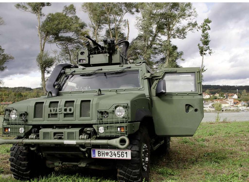
Das geschützte Mehrzweckfahrzeug «HUSAR» verfügt über ein 12,7 mm Maschinengewehr sowie Minenschutzsitze und ein ABC-Schutzsystem.
