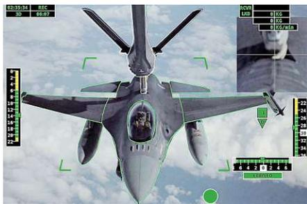
**Automatische Luftbetankungsanlage A3R von Airbus.**
